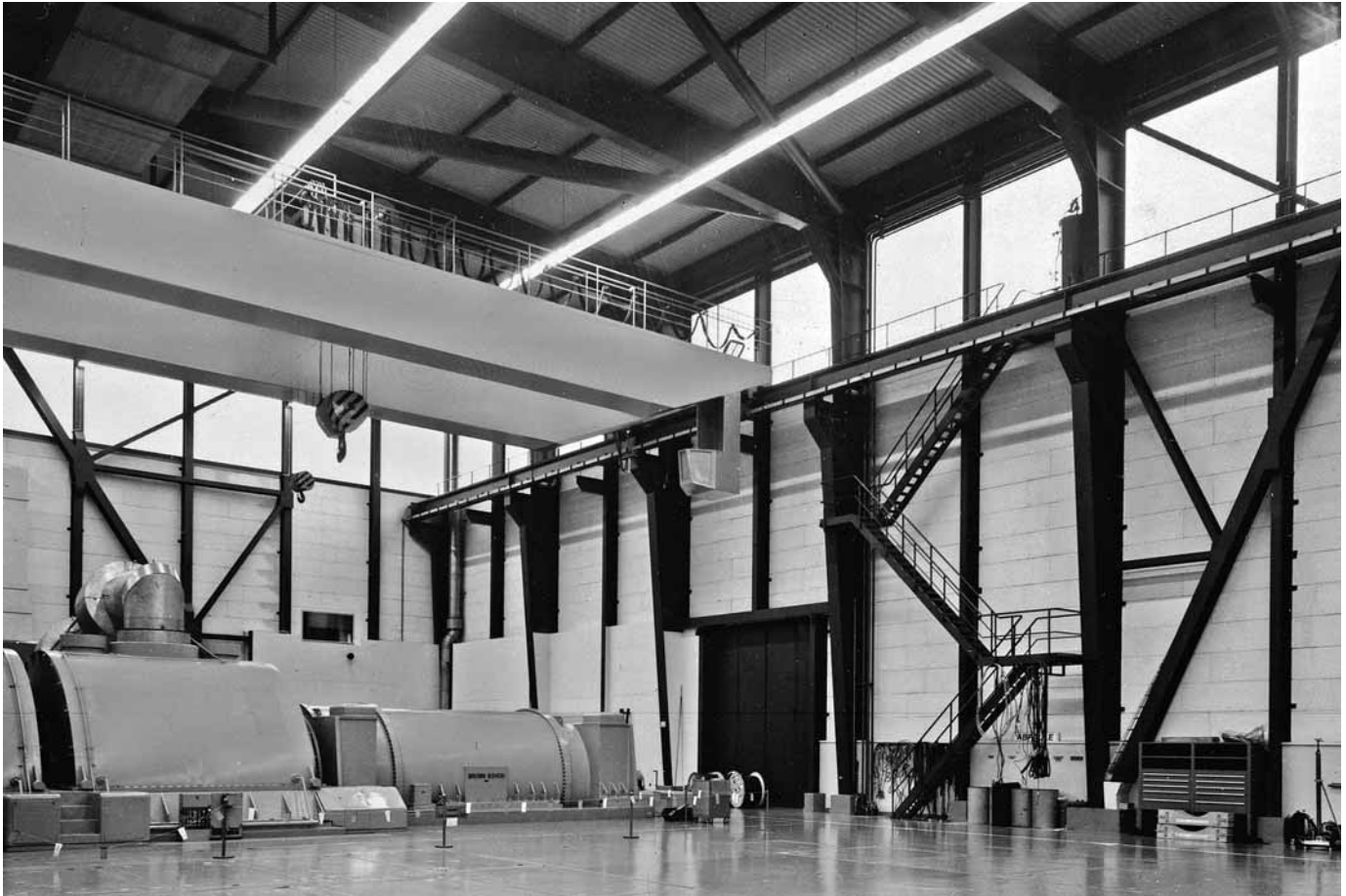
Bild 11: Treppenaufstieg zu Steuerstand und Wartungspodesten auf Zweiträgerkran.
